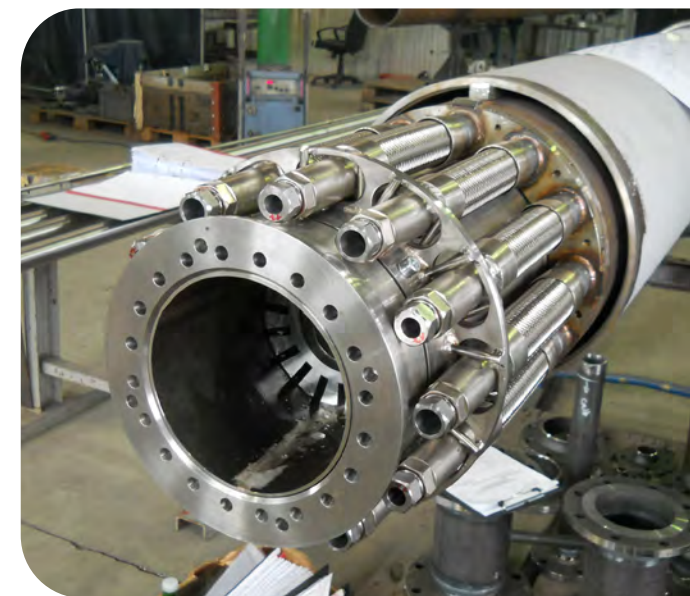
Brûleur de four au gaz M.A.S./2/EG/SG, avec son tube-enveloppe divisible retiré.
