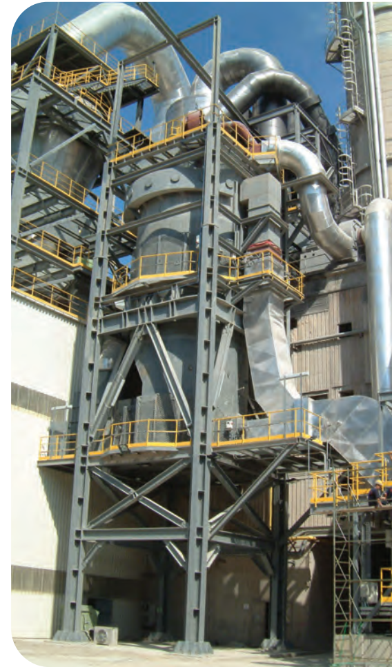
Type HG ————— Conception verticale | Combustibles : coke de pétrole, gaz naturel
