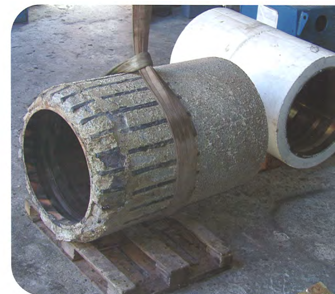
Новая передняя секция (длиной 1200 мм) наружного кожуха (на заднем плане), подготовленная для замены старой изношенной секции (на переднем плане)
